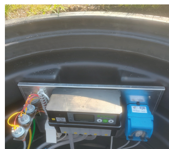
Figur 7: Platen festes på "vortene" i skjøtehal
